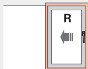
Schema B 1 Schiebeflügel (L o. R) Rahmen innen mit Wand bündig
