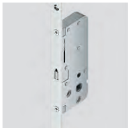
Türfänger (TF) ersetzt die "Kette" an der Wohnungstür, wird von innen über einen Knauf aktiviert und kann über den Schließzylinder von außen deaktiviert werden
